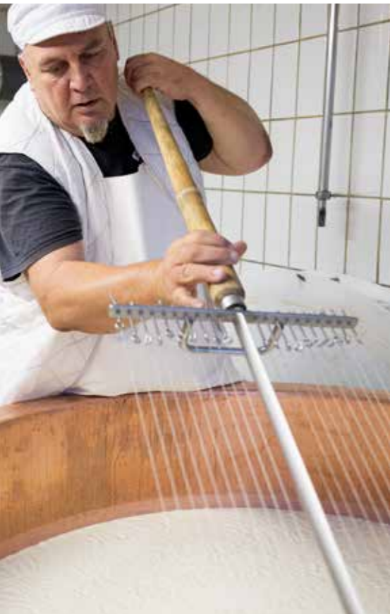
La masse coagulée est découpée en petits grains à l'aide d'un tranche-caillé.
