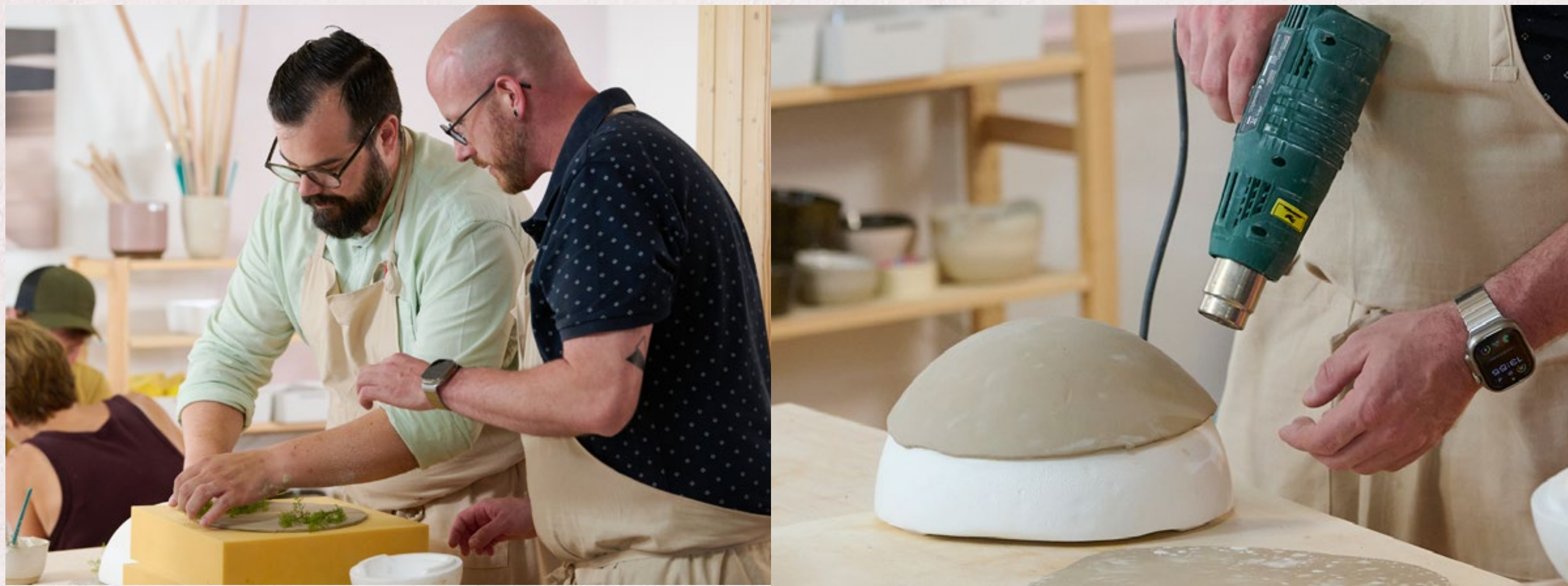
Pour la technique des plaques, l'argile est étalée au rouleau, découpée et posée dans ou sur un moule.
